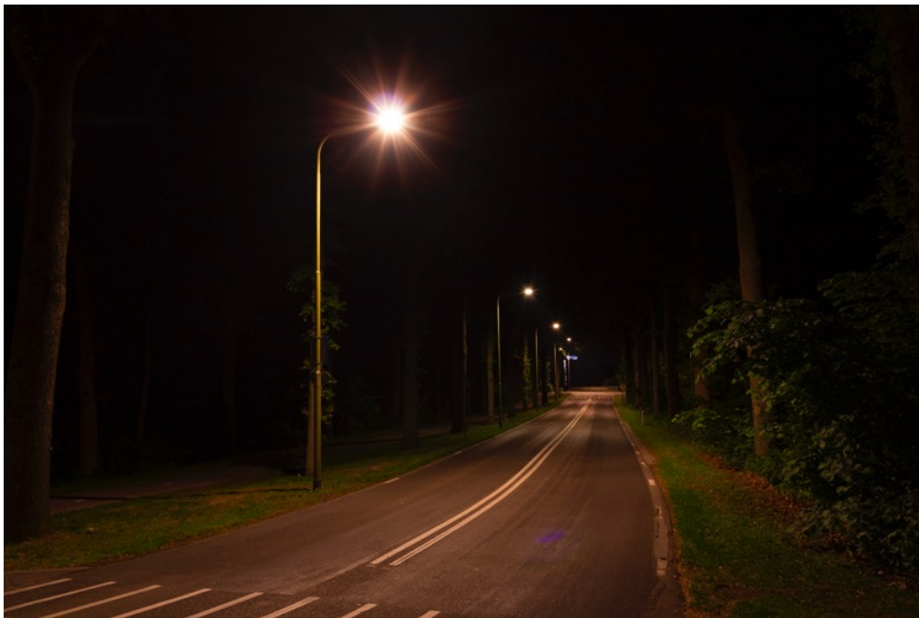
Foto: Dreef in Buren, doorgaande weg. Licht is gelijkmatig over de weg verdeeld zodat er geen zwarte vlekken zijn.
